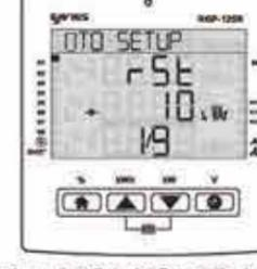
Sadece sürücü destekli modeller için (RGPSR) Otomatik SVC tanıma işlemi tamamlandığında OK tuşuna basarak ilerleyiniz (sürücüye bağlı tek fazlı gömme reaktörler).
