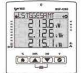
Halten Sie die OK-Taste 2 Sekunden lang gedrückt, um zum Menü Phase-Neutral-Spannung zu gelangen.
