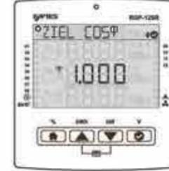
Geben Sie den Referenzstufe ein und drücken Sie OK. (Der Referenzstufe muss ein 3-Phasen-Kondensator sein.)
