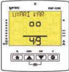
Cihazınızın bildirim ledi Kırmızı renk yanar. Cihaz bildirim modunun Kırmızı renk olması anlamına sisteminize ilişkin bir alarm durumu oluştuğunu bildirir. Cihazınızın herhangi bir tuşuna bastığınızda cihaz üzerinde oluşmuş alarmları görebilirsiniz. OK tuşuna basıldığında ekranda görülen alarmı erteleyebilirsiniz. OK tuşuna basınız.
