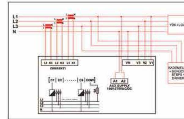
Sürücü Bağlantısı (RGP-12SR) / Inductive Load Driver Connection (RGP-12SR)
