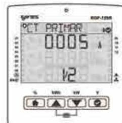
Geben Sie den Sekundärwert des Stromwandlers ein und drücken Sie OK.
