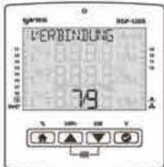
Das OK-Symbol leuchtet in der oberen rechten Ecke des Bildschirms auf. Sie können die Auf- und Ab-Tasten verwenden, um zwischen Hauptmenü und Untermenü zu wechseln. Drücken Sie OK.
