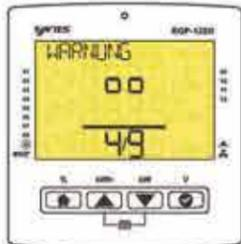
Die Benachrichtigungs-LED des Geräts leuchtet rot. Wenn der Benachrichtigungsmodus des Geräts Rot ist, bedeutet dies, dass eine Alarmsituation für Ihr System vorliegt. Sie können eine beliebige Taste auf Ihrem Gerät drücken, um die Alarme anzuzeigen. Wenn Sie OK drücken, können Sie den angezeigten Alarm schlummern.
